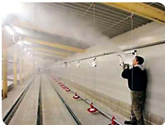
تست جریان ورودی هوا از دریچه‌های ورودی با استفاده از دود
